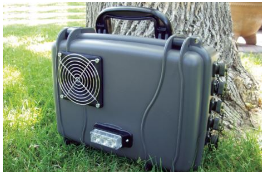
სურათი 9: „ScareCall“, სრულად პროგრამირებადი სინათლისა და ხმის მოწყობილობა, რომელიც შეიძლება დამაგრდეს ღობეზე ან ხეზე საძოვრის ტერიტორიაზე გარეული ცხოველების შემოჭრის თავიდან ასაცილებლად. მოწყობილობამ შეიძლება გამოსცეს მოულოდნელად გააქტიურებადი სინათლისა და ხმაურის ეფექტი (მაგ., სროლის ხმა). წყარო: (Shivik, 2006)
